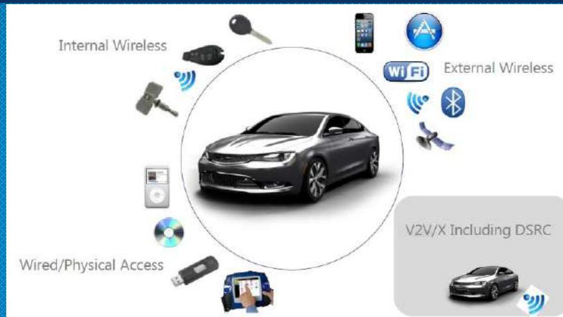
Il **veicolo connesso** offre la possibilità ad un **hacker malevolo** di prendere il controllo di molti sistemi ed eseguire azioni che mettono in pericolo la normale funzionalità del veicolo e dei suoi occupanti.
